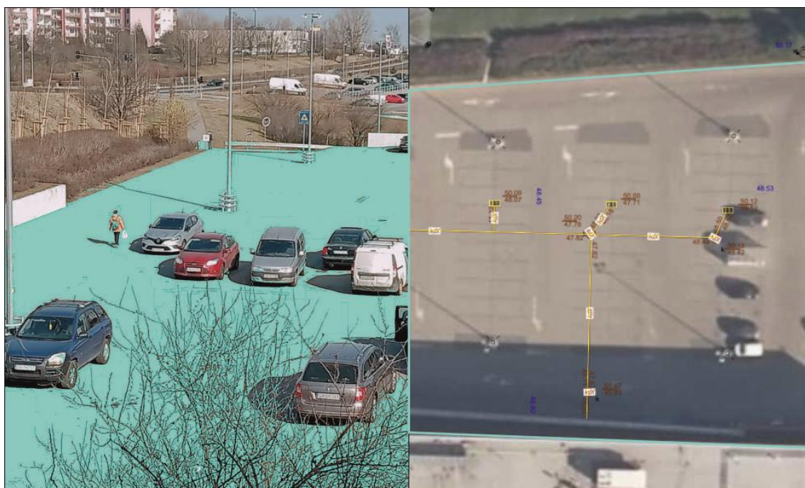
Ryc. 5.3.3. Wizualizacja scenariusza "2+" wraz z lokalizacją studzienek oraz przyłączy. Kolorem niebieskim oznaczono zakres możliwej modernizacji na podstawie danych dyrektywy INSPIRE
